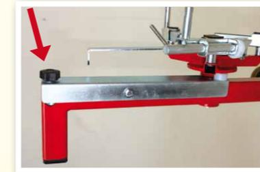
Durch das Drehen des unteren Drehtellers wird eine Sogwirkung zwischen Rührer und Behälter erreicht. Der Honig wird optimal gerührt. Sollte sich der Eimer zu schnell drehen, können Sie an der vorderen Stellschraube die Drehzahl regulieren.
