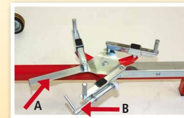
Der Drehteller kann mit Hilfe des Hebels (A) verstellt werden. Vom 12,5 kg Honigeimer bis zu 40 kg Hobbock. Nach dem Einstellen der Eimergröße muss diese mit dem Spannhel (B) geklemmt werden.
