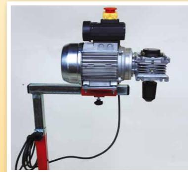
Motor mit Motorplatte (Nr. 3) auf den Galgen (Nr. 1) aufschieben.
