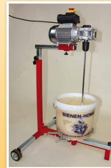
Bitte stellen Sie den Motor so ein, dass der Rührstab außer Mitte rührt. So wird der komplette Honig im Eimer gerührt. Der Rührmeister ist für den Dauerbetrieb ausgelegt.
